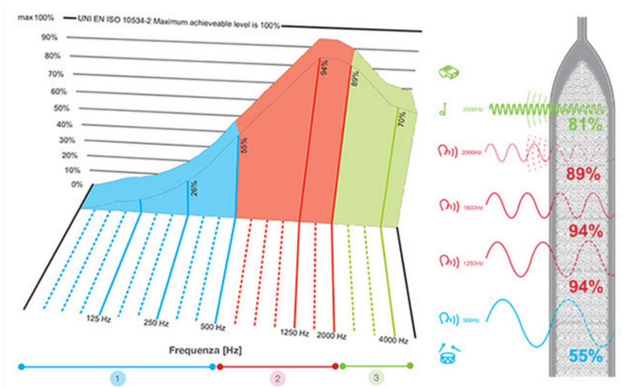
1\_ malgré l'épaisseur réduite ils absorbent relativement bien les basses fréquences (au-dessous de 500 Hz), c'est-à-dire les fréquences qui caractérisent les sons graves normalement difficiles à contrôler
